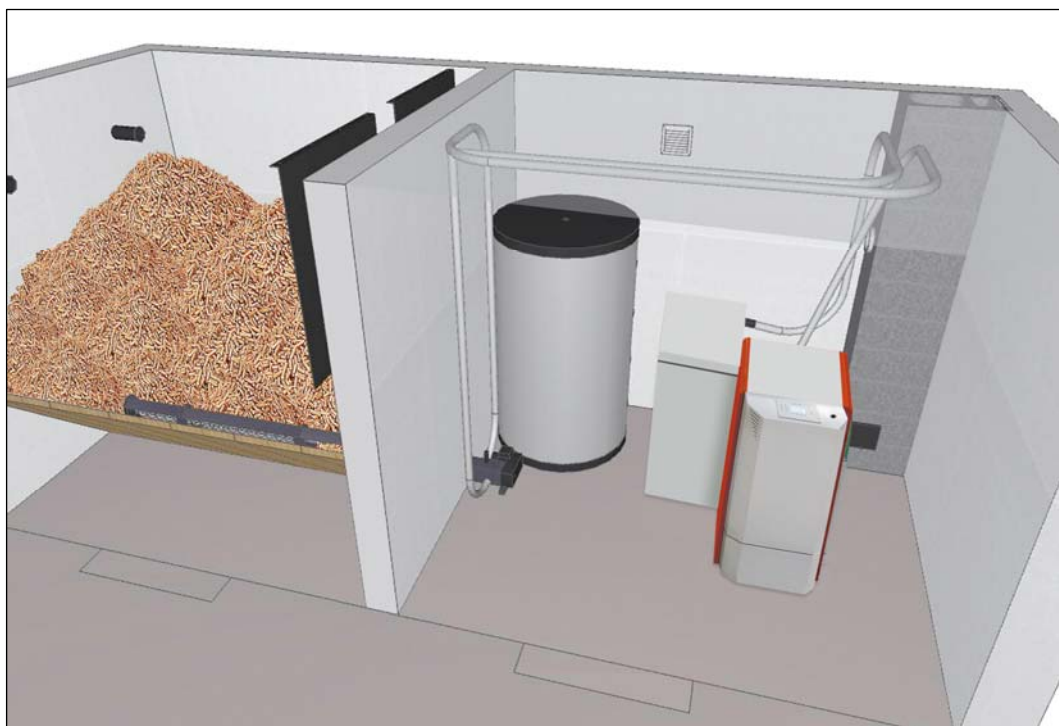
Рисонок 3 Котел Bio HiQ с комбинированной подачей топлива.
