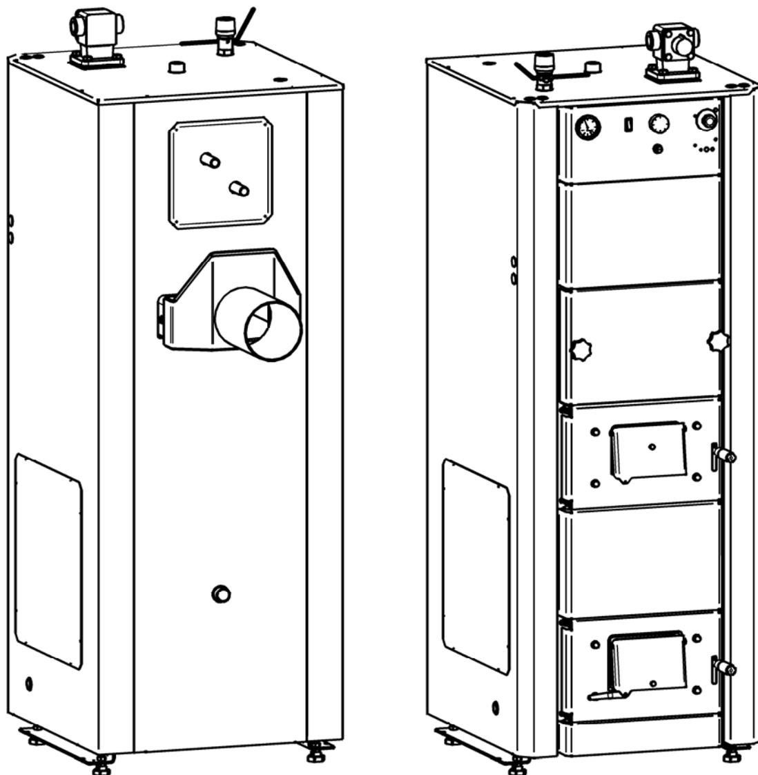
Посменный котел JÄSPI VPK предназначен для эксплуатации на дизельном/газовом топливе или твердом топливе, и на электроэнергии. К постоянному оснащению котла при поставке относятся оборудование для эксплуатации на твердом топливе и 6 кВт электротэн (под заказ 2 x 6 кВт). С обеих сторон котла также расположены отверстия для возможной установки пеллетной горелки.
