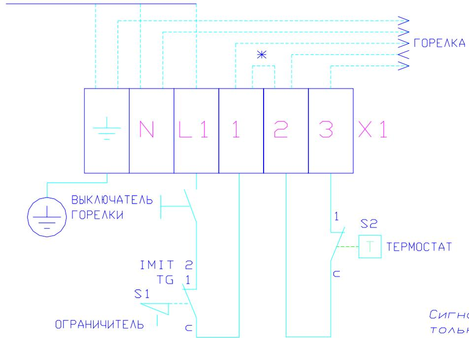
\* Внимание! В системе с 3-проводной горелкой соединить клеммы 1-2 и напряжение к горелке от клеммы 3.
